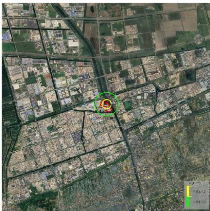
图 7.4-9 最常见气象条件下二甲胺储罐连接管道破损导致泄漏最大安全距离图
