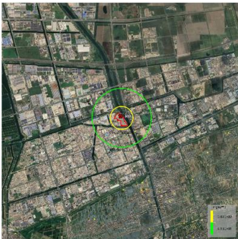
图 7.4- 50 最不利气象条件下环氧乙烷储罐连接管道破损导致泄漏最大安全距离图
