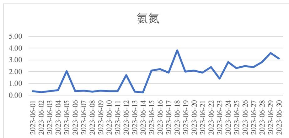
图3.5-7 废水在线监控图-氨氮
